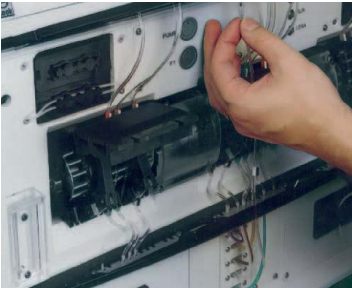
快速连接接头使更换泵管更快更容易
