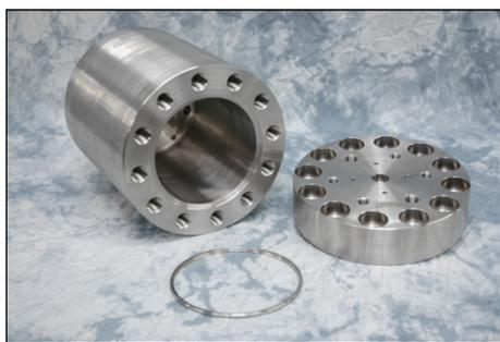
独特的高温高压容器以及压力平衡装置，为使用者提供了一个动态密封的系统，使得拉伸机疲劳试验，可以在一个完全模拟某种现场真实的腐蚀环境中进行。
