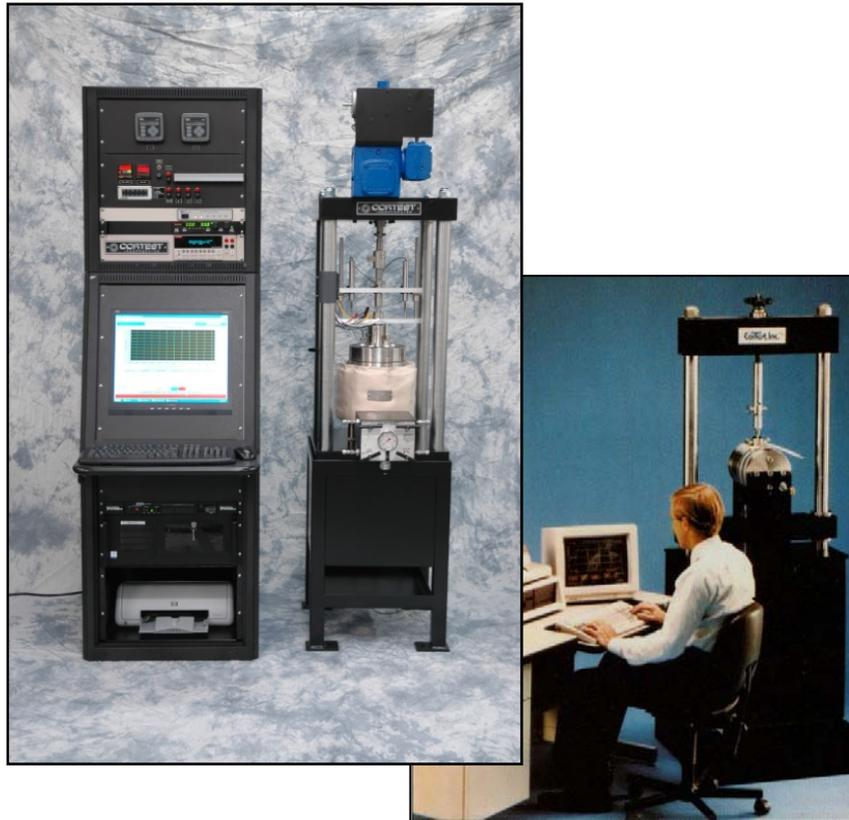
CORTEST 慢应变速率应力腐蚀试验机为在高温高压腐蚀环境下的腐蚀疲劳、腐蚀拉伸试验提供了一种可能。
