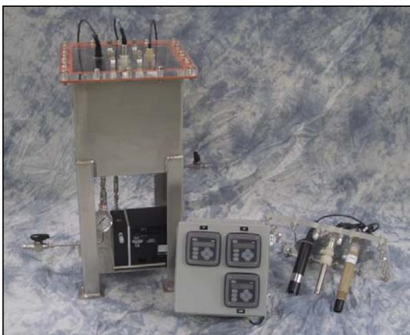
RTL 循环测试回路可在试验过程当中，对腐蚀环境容器内的试验介质进行连续补充，更新，以便维持腐蚀环境的恒定。由于介质进给是由一台流量可以精确控制的蠕动泵实现，所以，介质补充量可以达到非常低并且非常稳定的状态，因此，容器内的腐蚀环境不会被补充进来的新鲜介质所破坏。
