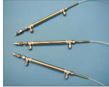
威廉池：如电化学试验条件超过 220C，例如超临界的 600C，则需要使用外置的威廉池电化学盐桥。该装置将试验介质引出到外置参比电极，并由一个高压蠕动泵将 KCl 溶液以极低的量注入到参比电极上，由于注入量极低，且试验过程保持正向压力，不会对容器内的腐蚀介质带来任何污染。
