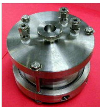
容器通过合金管路与环境室的控制面板相连，以此可以控制测试气体的进入和清除。实验温度是由外部的加热器通过计算机控制系统中的温度控制单元来控制的。
