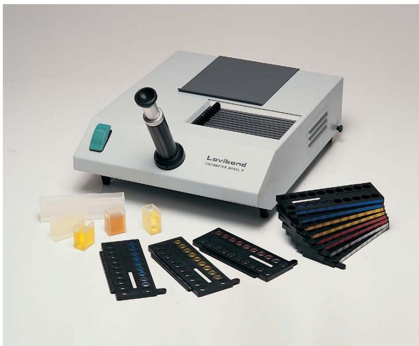
Model F先进的Lovibond目视比色仪，采用历经百年的Lovibond色度标准，其领先的现代工艺技术改善了传统的目视比色法。Lovibond色度标准是基于一系列经精确校准的有色玻璃滤光片，包括红色、黄色和蓝色，颜色由浅至深。有色滤光片的各种组合可匹配几乎所有样品的颜色。Lovibond色度标准广泛应用于透明产品，包括：油品、液体化学试剂及糖浆，同时也可用于不透明样品测量，如：脂肪和胶状物。
