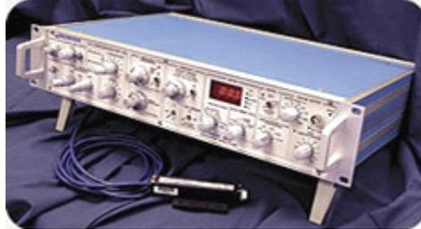
Axopatch200B 放大器是美国 MD(Axon) 公司设计的专门用于细胞膜电位信号放大的钳制放大器。
