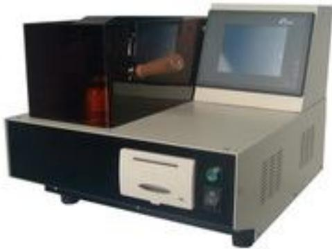
自动快速平衡闭杯法
