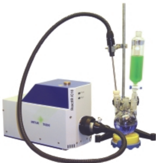
ReactIR™ iC10应用ATR探头插入反应体系中进行原位跟踪, 无需取样, 实时结果
