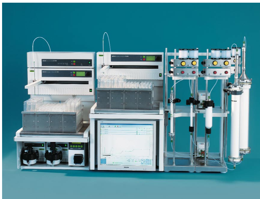
控制Sepacore专业级别中压制备色谱系统的SepacoreControl，包括四个泵、紫外检测器与示差折光检测器、两个馏分收集器及一个多柱阀模块。
