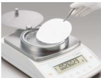
特殊设计的滤膜称量：CPA2P-F，例如：测定柴油发动机燃烧后产生的颗粒物残留
