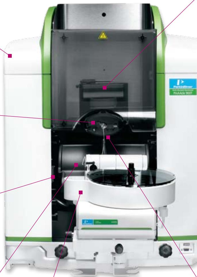
**独特的堆栈火焰/石墨炉设计** — 所有分析技术都仅需一个通风孔, 简化了安装程序, 并最大程度上减少了成本。
