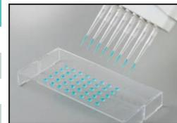
注：大多数厂家生产的 $10\text{ }\mu\text{l}$ 吸头都可以适配 $20\text{ }\mu\text{l}$ 的移液器
