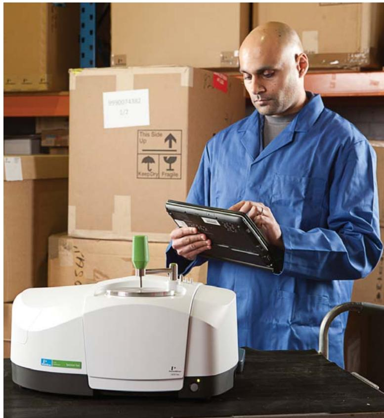
Spectrum Two 集成了许多特点，支持在实验室外进行红外分析。Spectrum Two 有多种电源供选配，无论是否具有外部主电源，都能够工作。通电后，快速预热功能方便了快速进行测量，同时，还可利用可选的无线连接通过便携式 PC 进行控制。Spectrum Two 紧凑结实，用户可轻松地在不同位置间挪动它，此外，还具有用户安装功能，允许任何人在任何位置对仪器进行设置。
