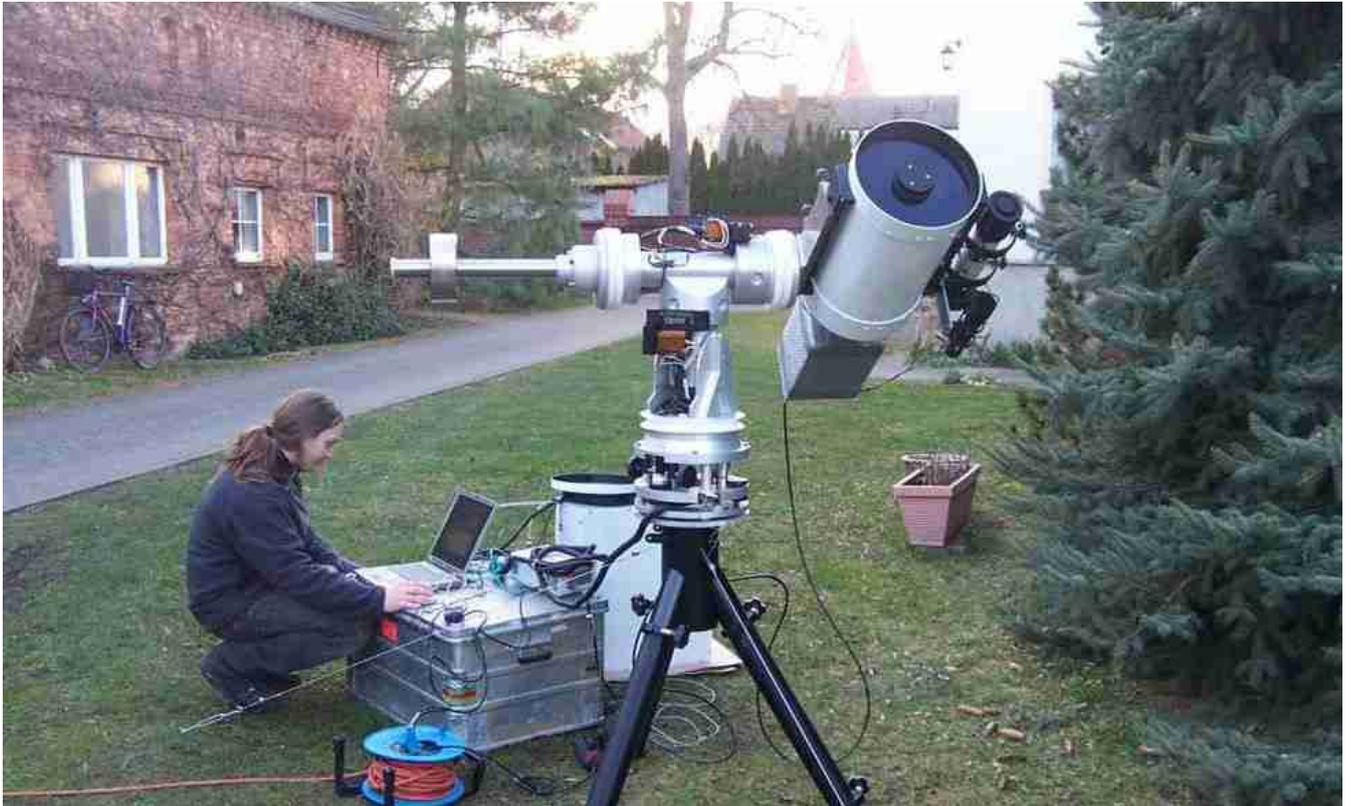
该仪器可用于夜间自动测试大气气溶胶光学厚度并进行数据分析，弥补了太阳光度计的不足。恒星光度计由一个主望远镜，光度计（带光学模块，CCD摄像头，小于9弧分），电子控制，自动跟踪系统，电源和扩展型软件包组成。其中的主望远镜配有一个反光镜，可用于视觉指向恒星，再利用附加在主望远镜镜筒上的导星镜（带CCD摄像头，53弧分），用于粗调瞄准恒星。
