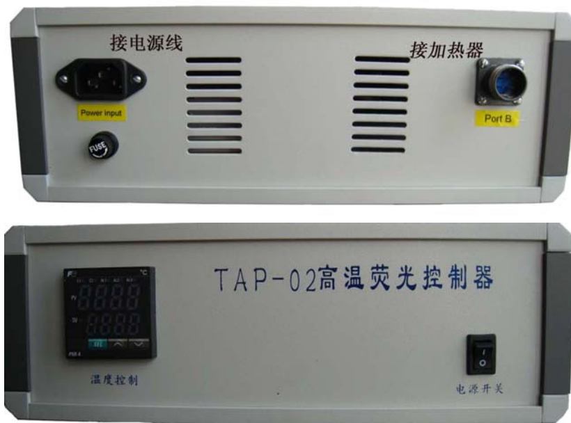
Figure 2. 控温仪前后面板的照片
