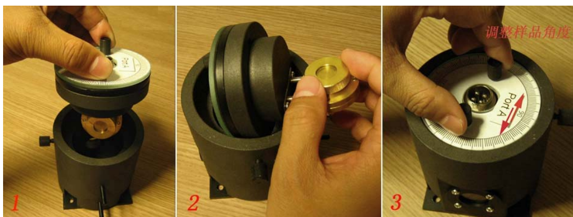
Figure 3. 示意的装样和调整角度。1. 取出加热头；2. 旋开压盖示意；3. 调整入射角度示意；
