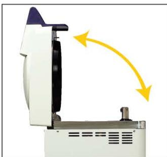
SX系列采用新型的“上掀盖”方式，用脚踏或单手就可以操作。“上掀盖”压紧时，当温度压力处于安全条件，只要踩踏机器底部的脚踏开关，“上掀盖”安全锁就打开了，因为有机械助力系统，“上掀盖”只需轻提就可打开。另外只需轻轻下压就可关上“上掀盖”。
