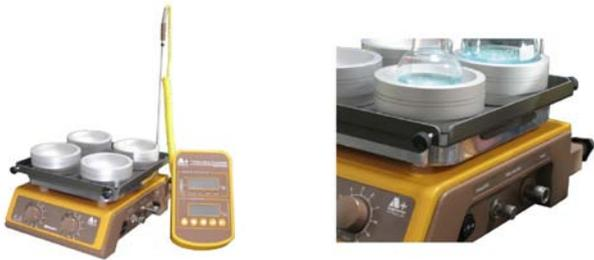
HPF 合成工作站适用于圆底烧瓶和样品瓶，可同时处理多个加热反应，HPF 加热磁力搅拌器自身含有冷凝水、惰性气体快速接口，使用安全、洁净。沙浴使得热量传质更快、更均匀，传热效果最佳，使用更方便。外接 PID 数显温度控制器，双重控温更安全、精准。此外，铝合金加热块热传递效果好且不会对磁场产生影响，有效确保各个容器温度一致、搅拌均匀。
