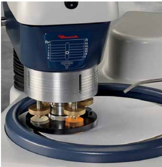
Vector® LC 250动力头提供一到四个样品的单点力加载。
