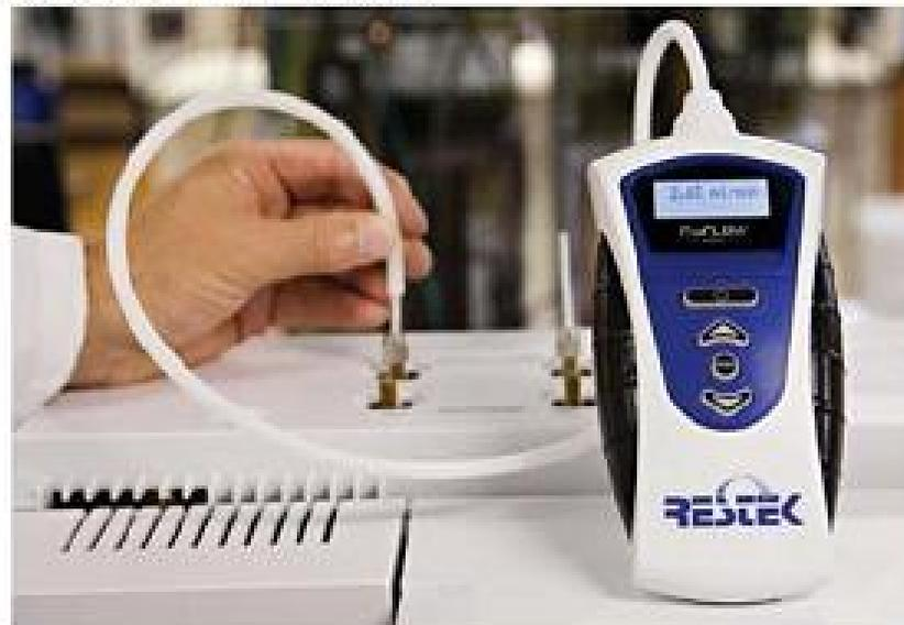
图5 LCD显示屏显示流量读数
