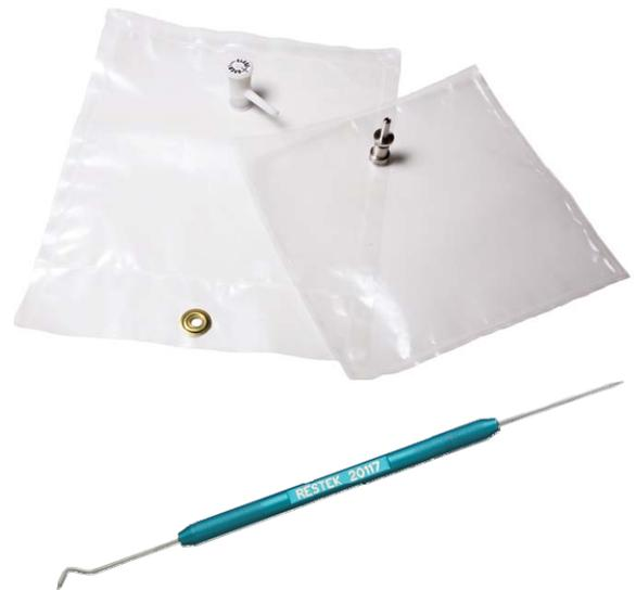
可以使用 20117 挑针取出气袋阀上的隔垫
