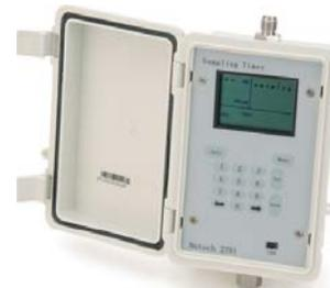
采用定时器可以自动或手动完成采样要求。可以用键盘或者图形显示对12个时间事件编程。可以方便地遥控启动和停止采样，也可以按照测试要求间断采样。在不使用时LCD处于睡眠状态，延长使用寿命。与任何采样罐和流量控制器可以匹配使用。特点：采样控制电磁阀，1/4" Swagelok® 进口出口接头，高惰性的不锈钢流路管线以及为户外使用的防水性能。
