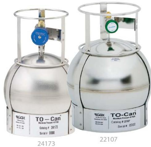
US EPA 空气监测规定的 TO-14, TO-15 要求使用经过处理的空气采样罐来采集和储存 VOC 气体。Restek 的 TO-Can™ 是使用专有电抛光技术和超声工艺来进行处理，完全满足这个要求。（相当于 SUMMA® 采样罐）。为了保证质量，罐的内表面需要进行钝化处理，使 TO14/TO15 的成分在储存中保持稳定。电抛光罐体球形外框架不用焊接记号，防止活性点出现。采用了 Parker Hannifin 的金属对金属薄膜阀保证了采样罐的性能。上面的把手也无需焊接，支撑了管道和阀。2/3 转的阀也是金属对金属密封，很容易判断是处于“开”还是“关”的状态。阀耐温 250°C。出厂时先采用氦检漏仪对罐和阀进行检漏，然后充灌高纯氮。
