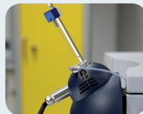
安装在APCI II 源上的固体样品直接进样探针
