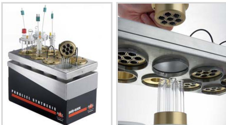
水冷型惰性气体保护和冷凝模块 配套反应釜和试管冷凝适配器
