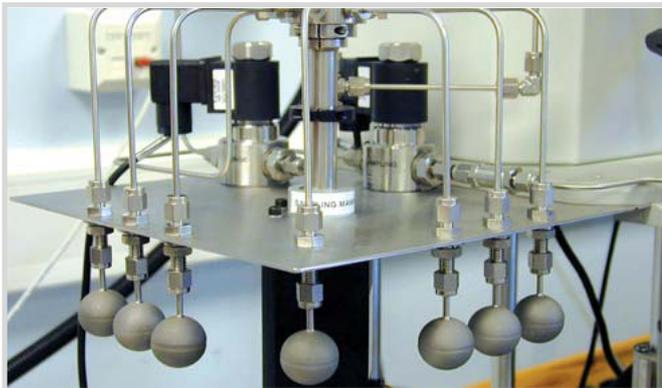
全自动高压取样系统（也可提供常压取样系统）
