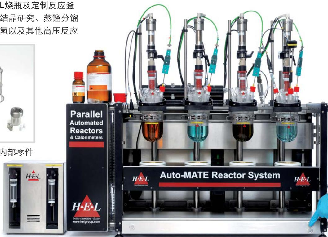
AM II 配置举例：AM4 + 常压釜盖 + 可快速更换的反应容器 + 各釜独立的温控系统 + 顶置机械搅拌 + 可移动夹套 + 冷凝介质恒压分配器 + 2路液体加料
