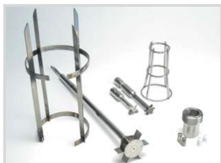
不同反应釜中可选不同的内部零件
