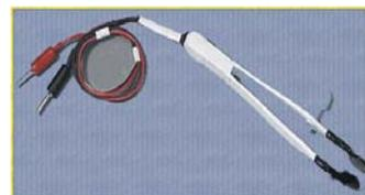
针状电极: 一种可重复使用的电极, 主要用于在动物体内进行药物或基因的传递。电极有 5 种型式, 直型、L 型、尖头、钝头, 可用于多种用途, 尖端为镀金材料。
