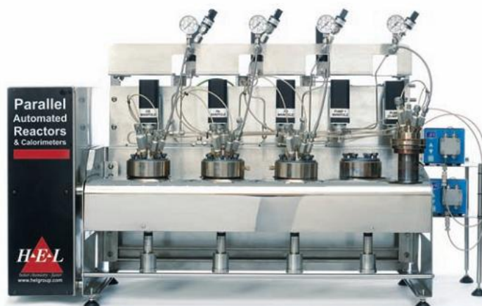
4x300ml 高温高压反应系统，悬停式磁力搅拌
