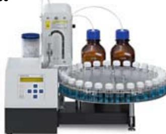
SC30样品进样和清洗单元有30个样品位，可一次测量30个样品。
