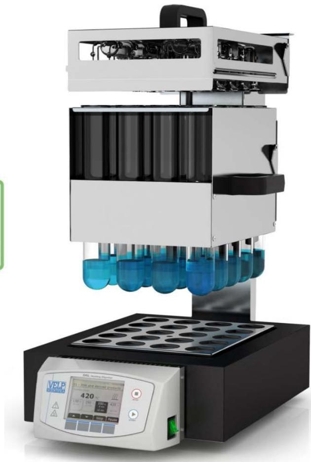
意大利VELP凯氏定氮消解装置DKL系列有广泛的应用：能应用于食品中氮和蛋白质含量的测定和分析；环境中化学需氧量分析、化学给药量分析。适用于固体、液体、半固体样品的消解，样品量为：5g/15ml。
