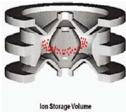
环状离子阱质谱TMS是最新开发的离子阱，同传统的柱形离子阱或线性四级杆离子阱质谱仪相比，它更微型化。结合GC，TMS可分析测定气体、顶空、液体、固体样品中的挥发有机物或半挥发有机物。样品被导入到GUARDION-7 GC-TMS后，目标化合物逐个分离开来，并通过保留时间和质谱进行定性定量分析。
