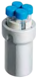
图示: #1398-吊篮 + #1483-A-适配器 + #0509-15ml有盖锥形底离心管
