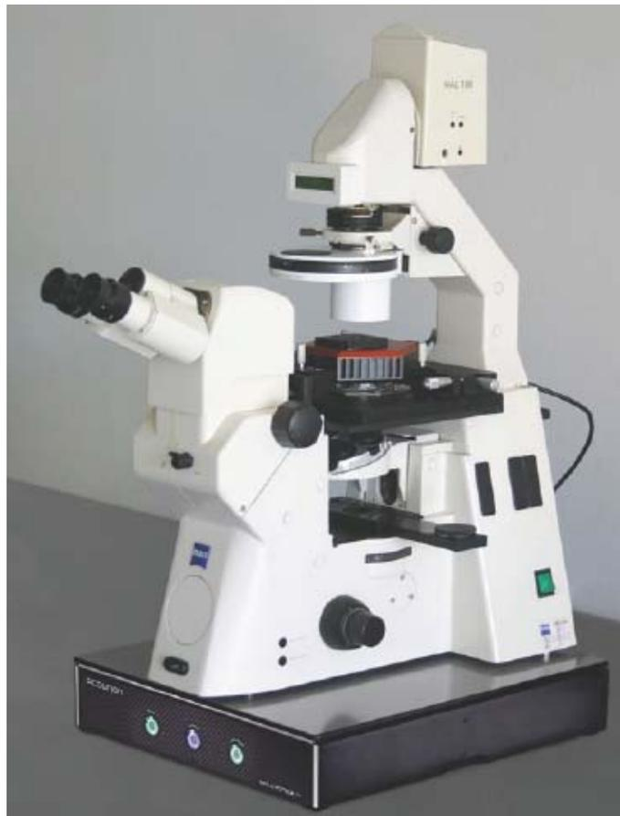
上图为倒置光学显微镜装置: easyScan 2 FlexAFM 原子力显微镜集成在 Zeiss 倒置光学显微镜上, 同时放在 Accurion 主动式减振平台上。
