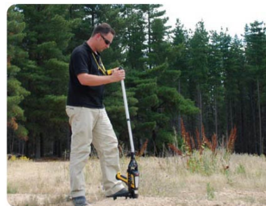
使用遥控支架进行原位土壤分析
