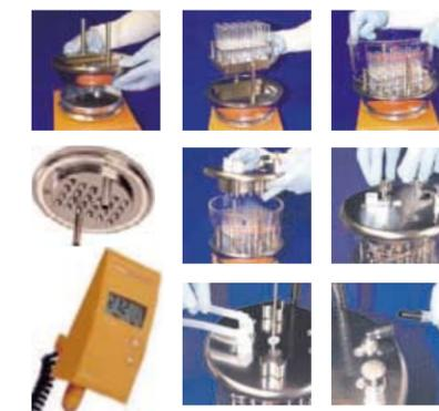
Carousel Fuzzy逻辑数显温度控制计精度为 $\pm 0.5^\circ\text{C}$
