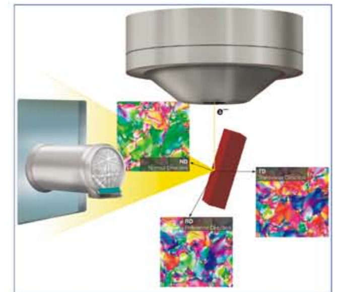
SEM样品室中EBSD探头、样品以及电子束之间的几何位置关系。
