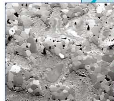
FSD图显示了石英-顽辉石复合材料的成分和取向衬度（图片由Dr. Karsten Kunze, Geologisches Institut, Zurich, Switzerland提供）。
