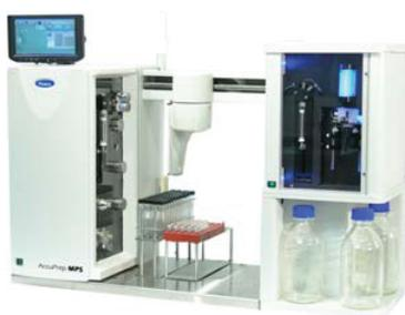
使用AccuVap™系统，就不须再使用其它浓缩装置来进行GPC分离净化后的浓缩，这样不仅简化操作步骤，而且减少了不必要的样品转移带来的回收率降低的问题
