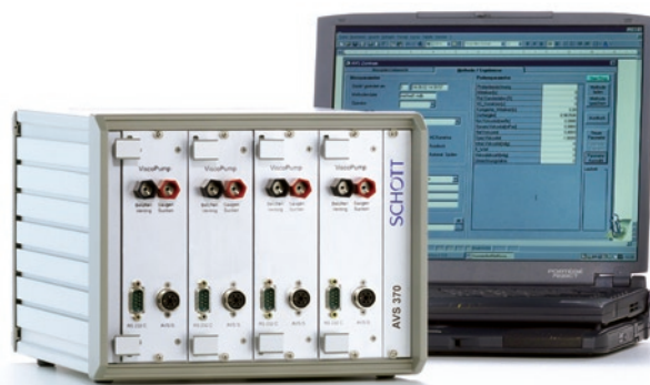
19吋標準機箱可配置4組ViscoPump II模組，由電腦及WinVisco370軟體精密控制（軟體隨機附贈、電腦為選購），從透明液體、到黑色不透光樣品皆可測量，能單獨評估各組樣品數據、製作完整的分析報表，彈指間即可完成設定！
