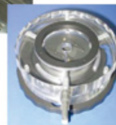
微量样品池：能够在夹持器间放置极小的样品碎片。
