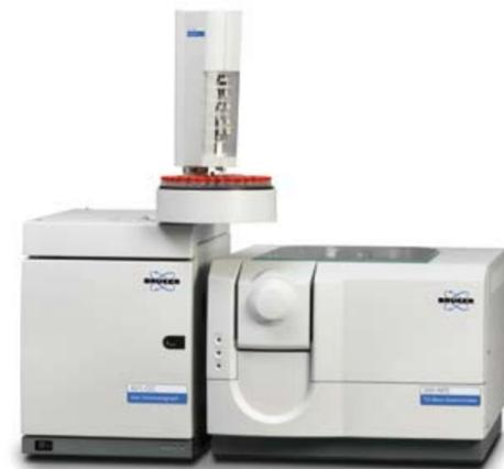
Bruker 300-MS 配置 431-GC 和CP-8400 自动进样器，提供了紧凑、易用型质谱仪的最高性能。
