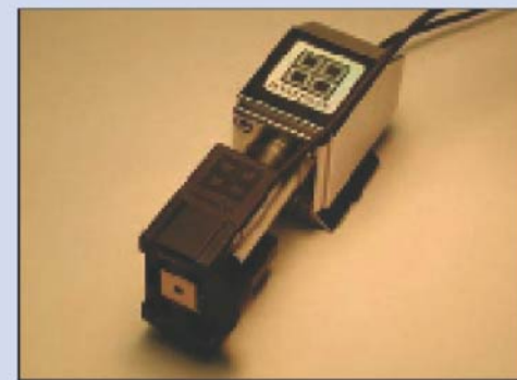
TriboScanner 上的 Hysitron (海思创) 专利三板电容式传感器
