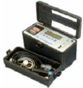
仪器配有大容量数据存储器，存储间隔从 10 秒到 30 秒可调，使用者能够很轻松的获取 17 个小时的测量值（每 10 秒钟记录一次）。通过软件“Compact tools”可以将储存的数据传输到计算机上。
