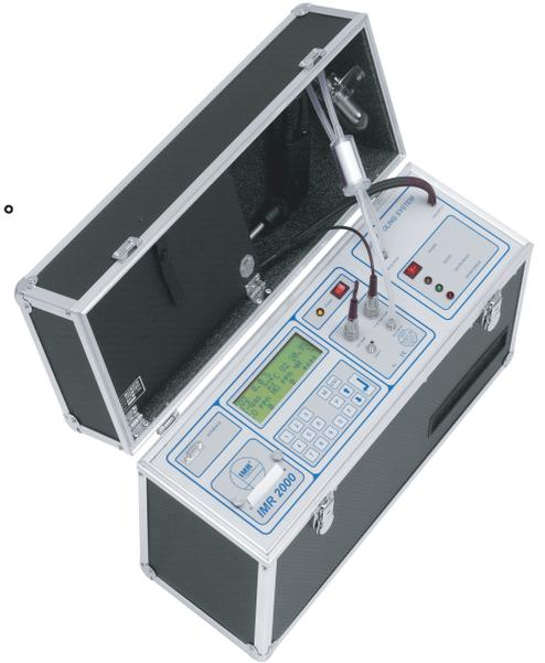
IMR2000具有可选择冷却装置的特点，是一款理想的工业型测量仪器。精度高，操作简单，灵活性强，可同时进行多点测量，分析烟气成分和工作过程。多种可供选择的规格不同的烟气探针以及可耐高温1550℃的陶瓷采样管使这款仪器更加独特和完善。
