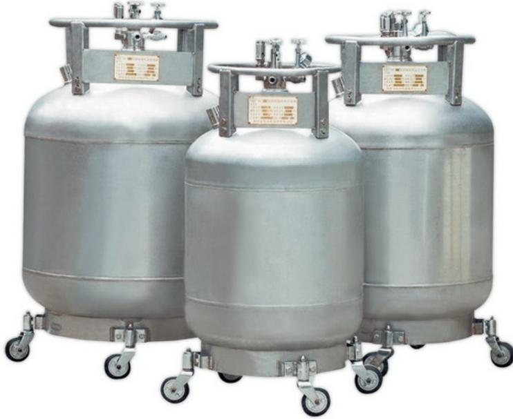
自增压式液氮容器，该系列产品采用奥氏体不锈钢制造。它利用开启升压阀将容器中贮存的液氮少量气化，由于液氮的气液体积比较大，气化后的氮气在容器内部产生一定的压力（安全压力范围内），开启排液阀后，容器内的液氮就在压力作用下自动排放出来，对其它容器或者设备充注液氮。具有使用安全可靠、排液方便快捷、静态液氮日蒸发率损失低的优点。
