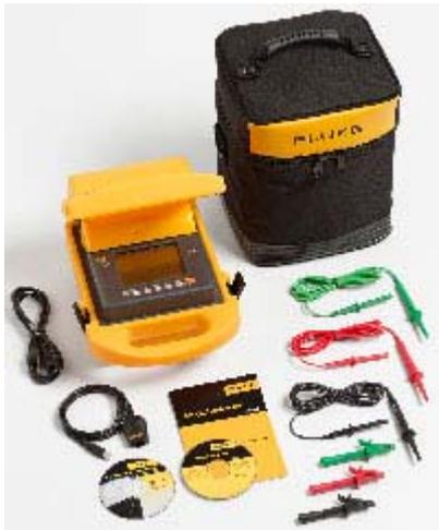
1550B 是一款数字绝缘测试表，可在高达 5000 V 直流电压下测试开关设备、马达、发电机和线缆的绝缘情况。1550B 可用于各种范围的测试：从简单的现场测试到定时测试和破坏性试验。测量结果存储能力和 PC 接口软件使其非常适宜于预防性维护工作。大负荷的测试线、探头和鳄鱼夹均可放在定制便携包内，作为坚固的现场测试套件提供。
