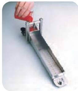
关闭储样槽门，取样品，75ml，倒入储样槽中。
