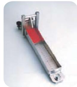
通过计时，对比在特定时间内样品流过的长度就可以准确计算出样品的粘稠度了。
