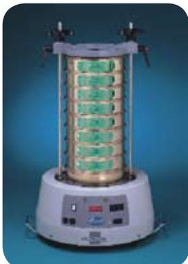
Endecotts OCTAGON数位式高速筛分仪特别适合实验室或工地现场使用，重量较一般震动器轻，易于运输；LED数字显示，清晰可靠；微处理器控制，设置容易；以电磁驱动器带动，不含会磨损旋转部件，操作时极为安静；数显控制器可以设置操作时间，振幅，亦可设置连续震动或间歇震动，间歇震动可以清除阻塞物增进筛分效果。
