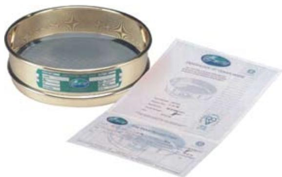
英国Endecotts筛网是现今符合最严格要求，广受全球实验机构采用的经济型精密筛网。Endecotts使用先进光学仪器及分析电脑，在制造过程中针对每一个筛网反复检验精确度。因此Endecotts出品的筛网最少须经过6次检验及1次复核，确认其品质符合标准后，才有资格打上Endecotts的铭牌，并提供检验合格证书，以保障每个客户购买到的是世界最高品质的分析筛网。
