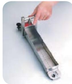
调节槽门锁，打开槽门，使样品瞬间流出储样槽。
