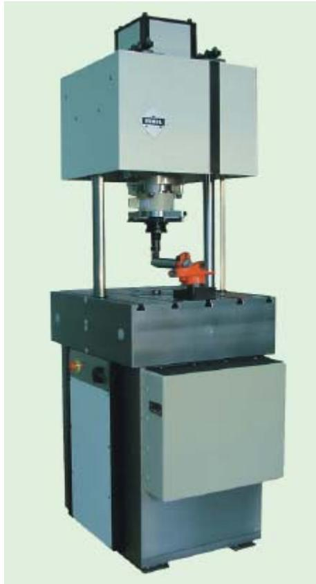
TESTRONIC 50/250 kN 共振试验机
