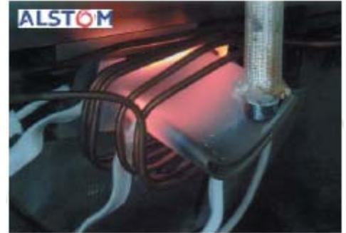
在 ALSTOM 有限公司（瑞士）燃气涡轮叶片 HCF 测试
