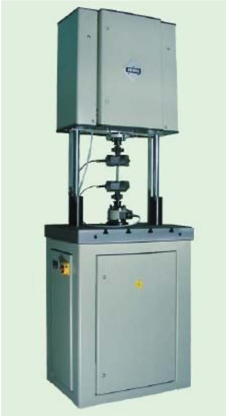
MIKROTRON 5/20 kN 共振试验机
