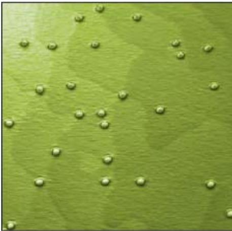
下垫面是清晰可见, 并确认该测量质量。在动力模式下成像的量子点。扫描大小 1 微米。全彩色刻度相当于 4 纳米。在基础表面下的单一原子排列清晰可见, 并可确认该测量质量。
