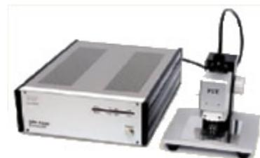
**Nanite** 扫描头安装在不同的测量平台：（左）定制的工业应用，（右）标准工作台样品台。
