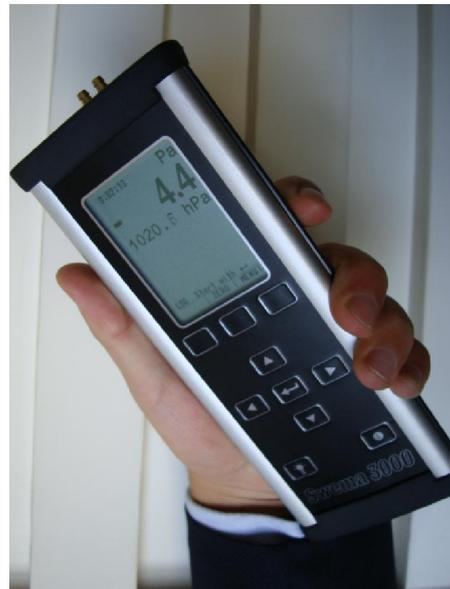
Swema 3000mdH+ 中的微处理机拥有十种不同的程序，每个程序都是为其特定参数的测量而特别设计的。用来计算平均值、最大值、最小值和标准偏差。电子记录本有 1600 个测量报告的容量。数据记录仪有 20,000 测量数据的容量。
