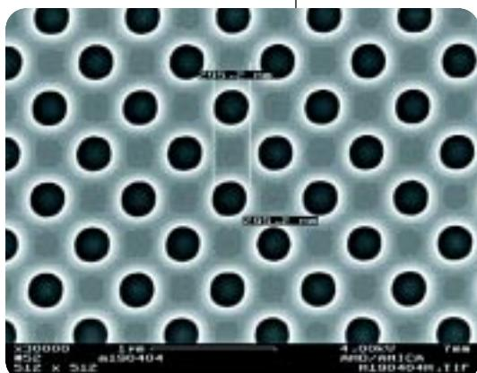
纳米压印光刻(NIL)以其分辨率高(纳米量级)、产量高、低成本的特点，正在获得越来越多的关注。NIL的原理比较简单，将刻有目标图形的掩模板压印到相应的衬底上——通常是很薄的一层聚合物膜，实现图形转移后，通过UV光照的方法或热压的方法使转移的图形固化，以完成微纳加工的光刻步骤。
