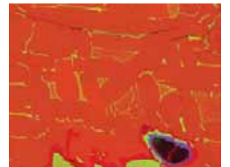
RGB 合并图：以 Fe (红)、Ni (绿)、S (蓝) 显示了一个紫色的硫铁矿相的结节 (FeS) 内部包含了一个石墨夹杂。
