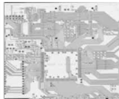
印刷电路板：总 X-射线强度图
