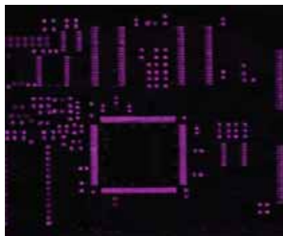
印刷电路板：Pd(L)的 X-射线面分布图
