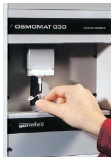
60 秒内测试完毕，自动显示读值及储存结果。升起支架取下测量皿，用纸巾或棉布将热敏感应器擦拭干净，即可进行下组试验
