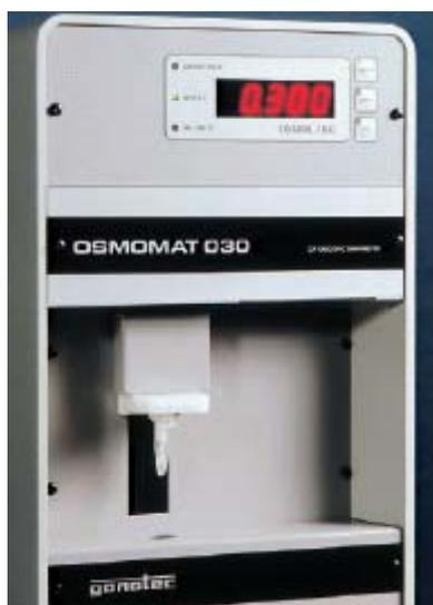
将盛有样本的测量皿装上支架，用手向下压入-7℃冷却槽中，立即开始测试
