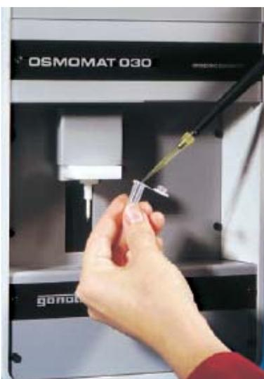
启动后 3 分钟快速冷却至工作温度，用微量吸管将样本注入塑料皿
