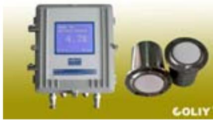
在线微波水分测试仪 M50D 由一个主机和 2 个探头组成，采用非接触透射式测量，探头不需要接触被测物料。主机采用了 5 英寸的工业触摸屏，操作简单；探头采用高强度不锈钢制造，功率为 30mW；主机和探头之间采用锁紧式防水联结件，带 3 米连接电缆。所有部件防水防尘，坚固的不锈钢外壳可抵抗意外撞击，整机可以在恶劣环境下长期工作。
