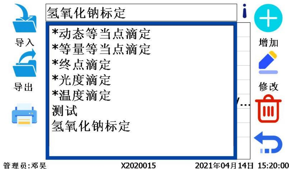
滴定方法分为预设模板方法（带※，不可修改）和用户新建自定义方法。预设模板方法包括：动态等当点滴定，等量等当点滴定，终点滴定，pH 测量，
