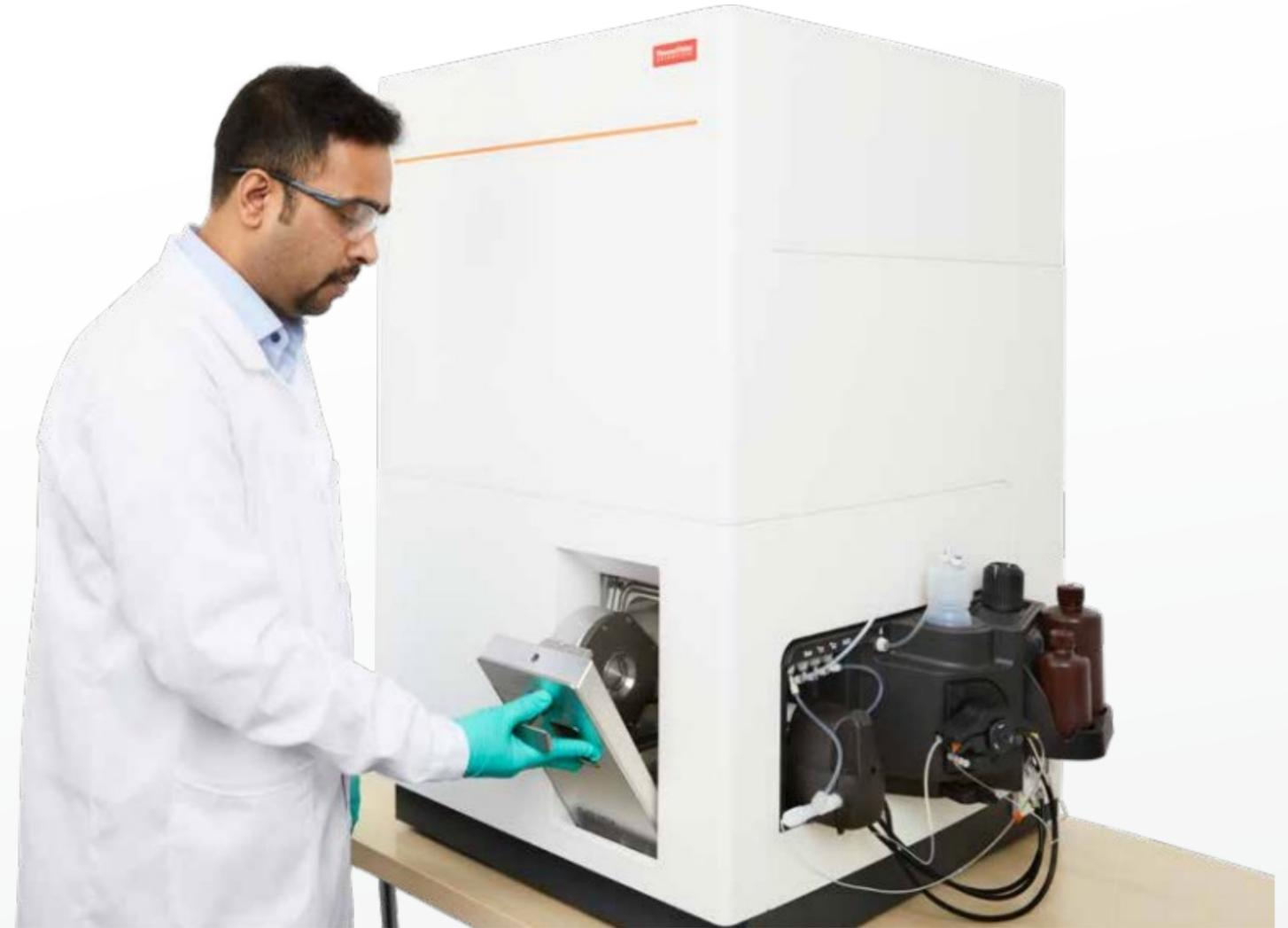
在高基质样品分析中，首次就能提供准确结果，确保不会出现漂移或 QC 失败。采用 IMH 和 AGD-25 对土壤和废水进行超过12小时的分析，结果表明高基质样品分析过程中仪器漂移极小。
