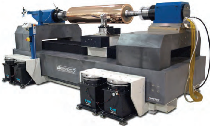
图片为Ametek生产的滚筒车床1400系列,它由8个专利性TMC MaxDamp隔振器支撑,负载总重约为5000英镑。整套系统使重约5000磅的轮辋上进行纳微米级操作,用于精密模具的成型加工。
